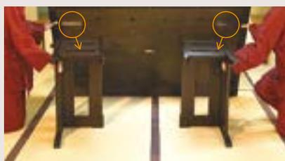
④天板裏のサンを脚の固定用枠に収めます。
